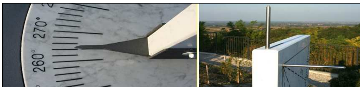
Figura 14. A sinistra si evidenzia al dettaglio la funzione del puntatore che indica l'azimut dell'astro inquadrato ad un'ora qualsiasi: l'azimut è = 265°. A destra si evidenzia l'asta verticale (in alto), che consente di allineare, fungendo come un vero mirino, la direzione della sua ombra con l'asse del piano orizzontale del Plinto.
